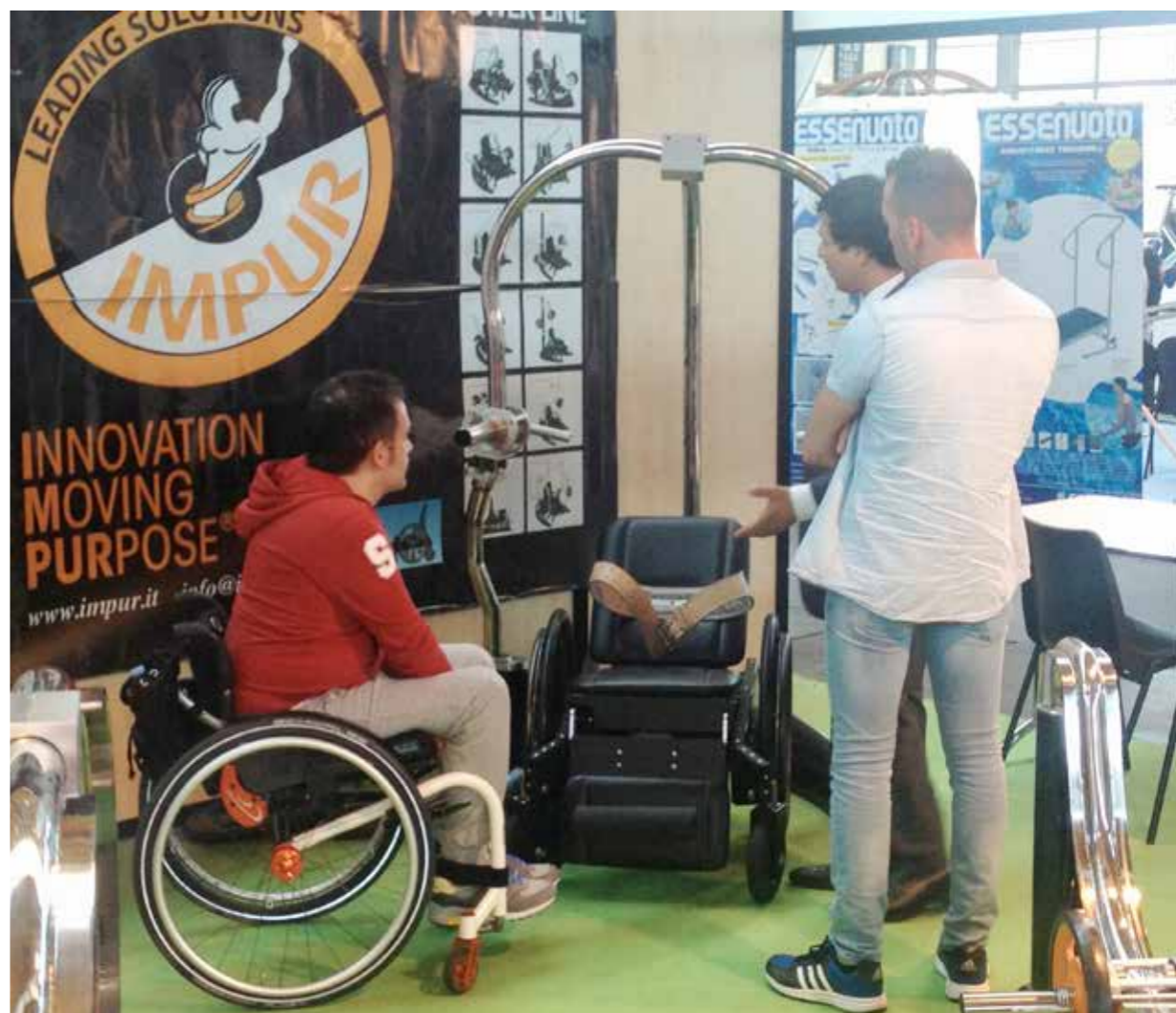
Con un meccanismo d'incastro la carrozzina viene integrata nella struttura del macchinario
